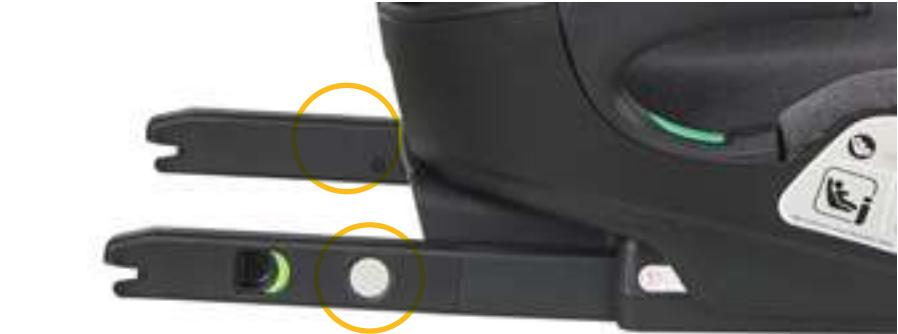
Presionar los dos botones conjuntamente para desbloquear el sistema isofix
